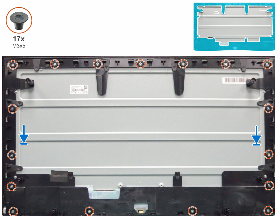
Figura 14. Installazione del telaio centrale per il modello S2725HSM
