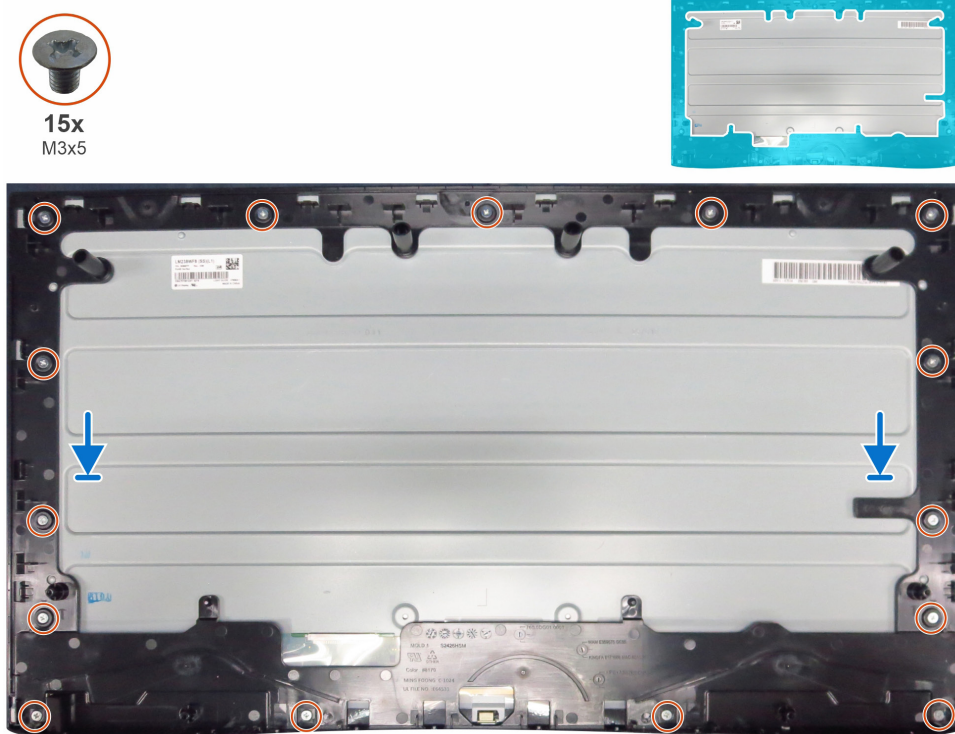
Figura 13. Installazione del telaio centrale per il modello S2425HSM
